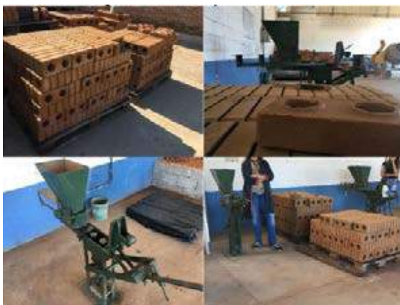
Figura 1: Fábrica de tijolos solo-cimento
