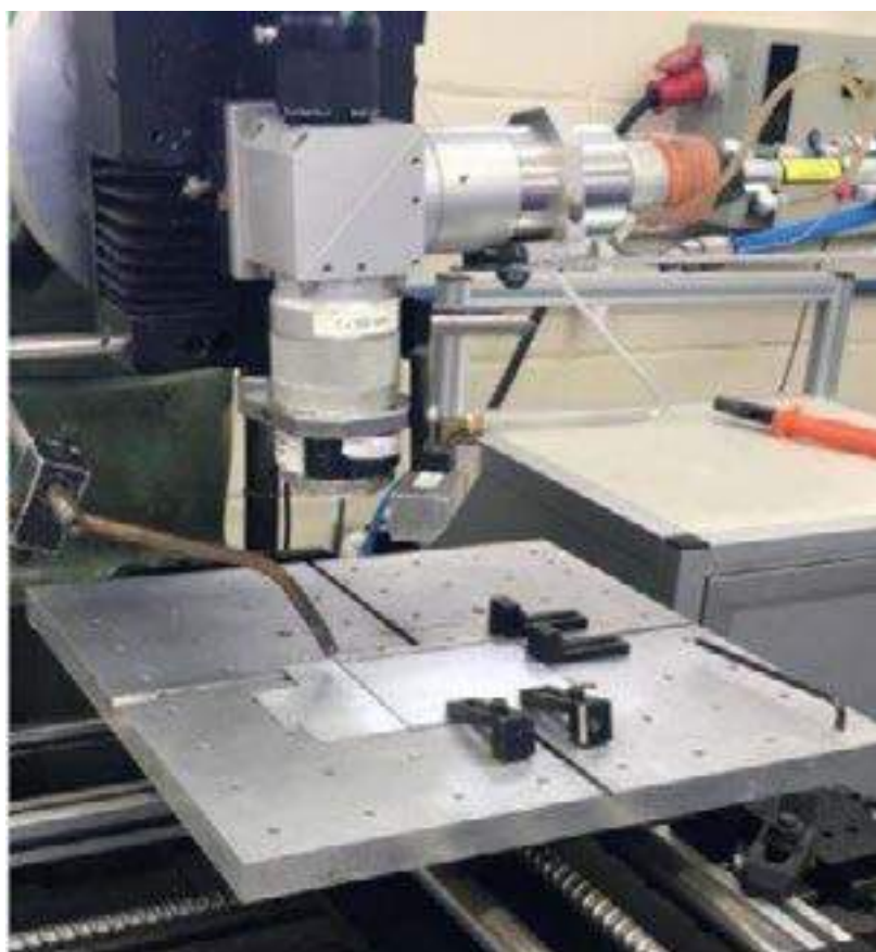
Figura 3 - Posicionamento da junta sobreposta na mesa CNC
