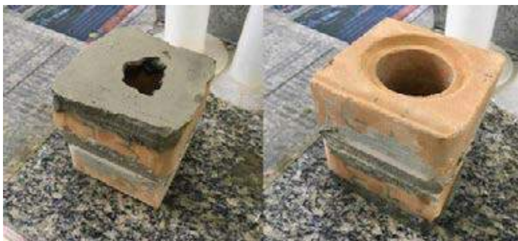
Figura 4: Tijolos cortados ao meio, superposto com a pasta de cimento e capeado
