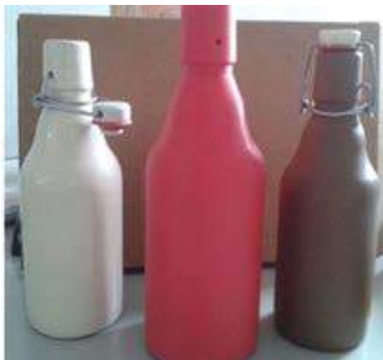
Figura 9 — Protótipo de material polimérico impresso (vermelho) e os pilotos em cerâmica para testes.
