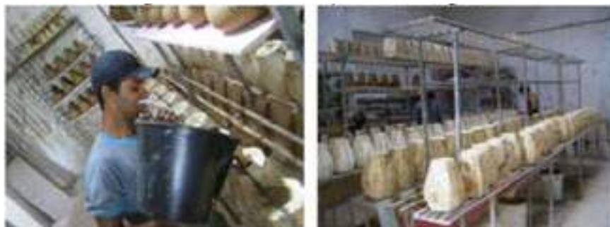
Figura 15 — Processo de Fundicao em moldes de gesso.
