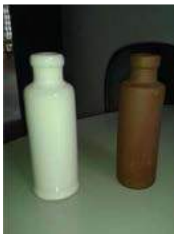
Figura 18 — Acabamento corn a utilizacao de esmalte (bronco\ e sem esmalte (terra cota).
