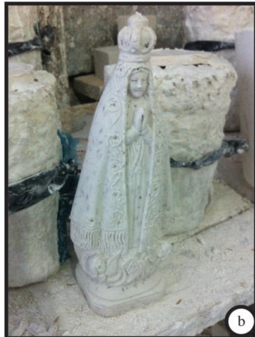
Figura 3 – Mistura do compósito (a) e artefatos desenvolvidos com gesso e cascas de arroz in natura (b) na empresa JB.
