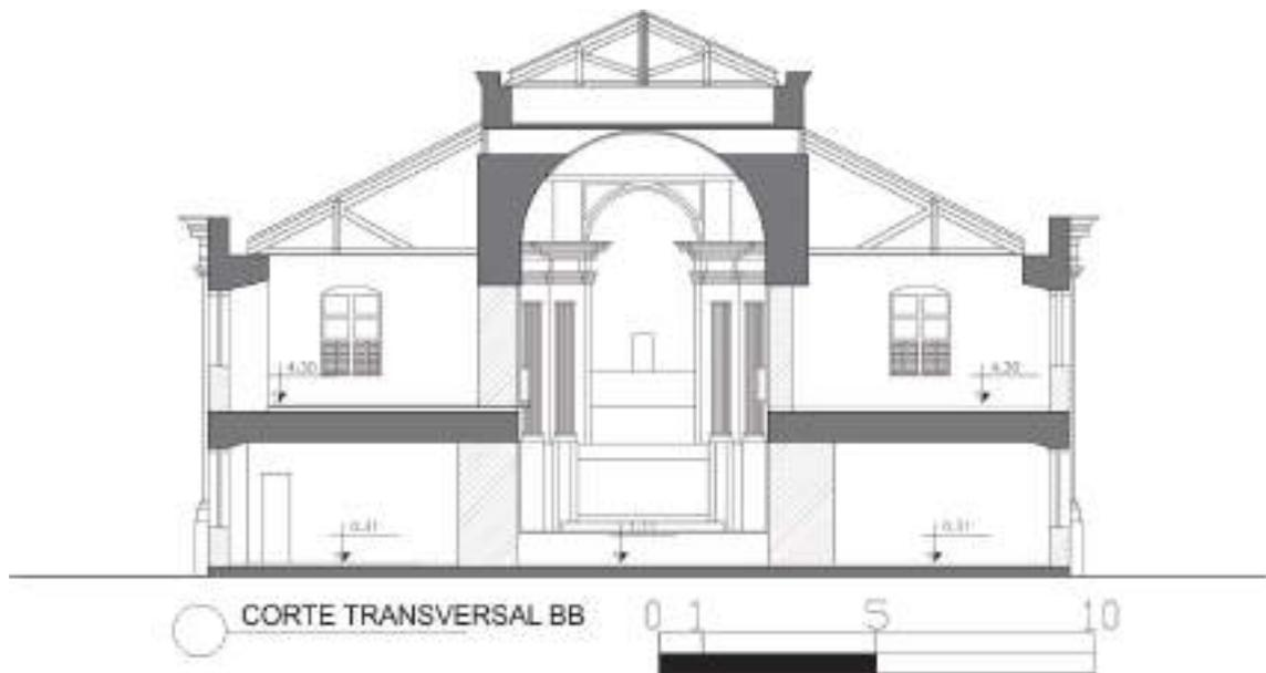
Figura 5: Corte transversal esquemático da Matriz Basílica Velha de Nossa Senhora Aparecida
