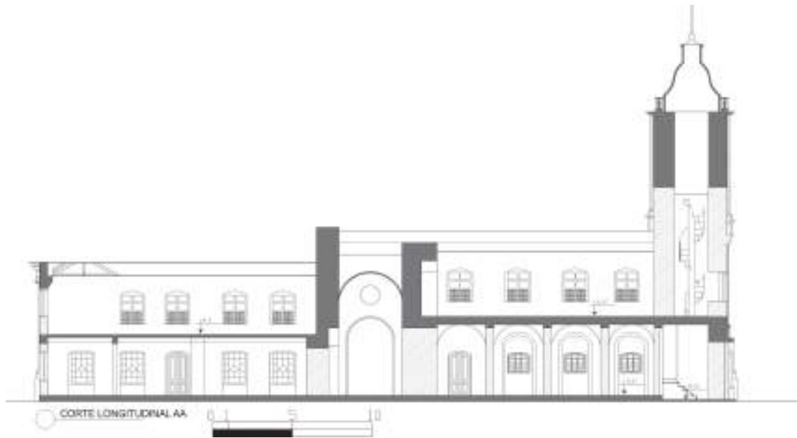
Figura 4: Corte longitudinal esquemático da Matriz Basílica Velha de Nossa Senhora Aparecida
